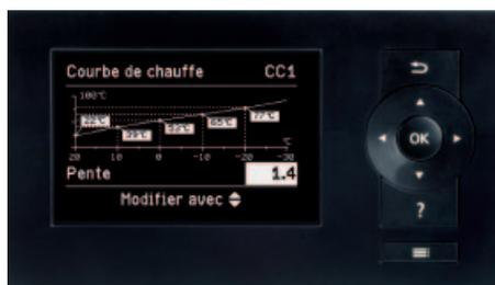
Nouvelle régulation Vitotronic – facilité d'utilisation grâce au guidage de l'utilisateur par menus et à l'affichage graphique, exemple des courbes de chauffe
