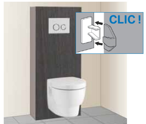
3 Fixation de la cuvette suspendue et de la plaque de déclenchement.
